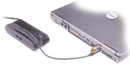
AC 어댑터는 AC 전원을 컴퓨터에서 사용하는 DC 전원으로 변환합니다. 컴퓨터가 꺼져 있거나 켜져 있을 때 AC 어댑터를 컴퓨터에 연결할 수 있습니다.
