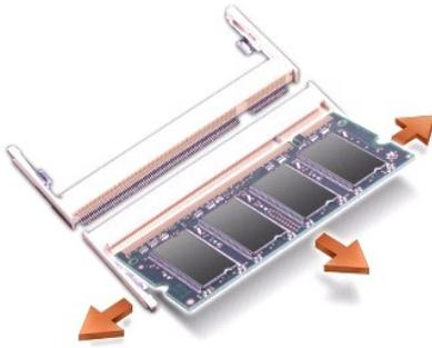
➡ **알림:** 2개의 커넥터에 메모리 모듈을 설치해야 하는 경우에는 "JDIM2 (DIMMB)"라고 표시된 커넥터에 모듈을 설치하기 전에 "JDIM (DIMMA)"라고 표시된 커넥터에 메모리 모듈을 설치하십시오.
